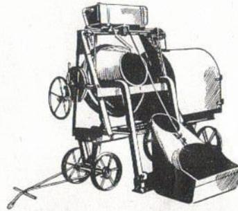
Beton- und Trogmörtelmischer
